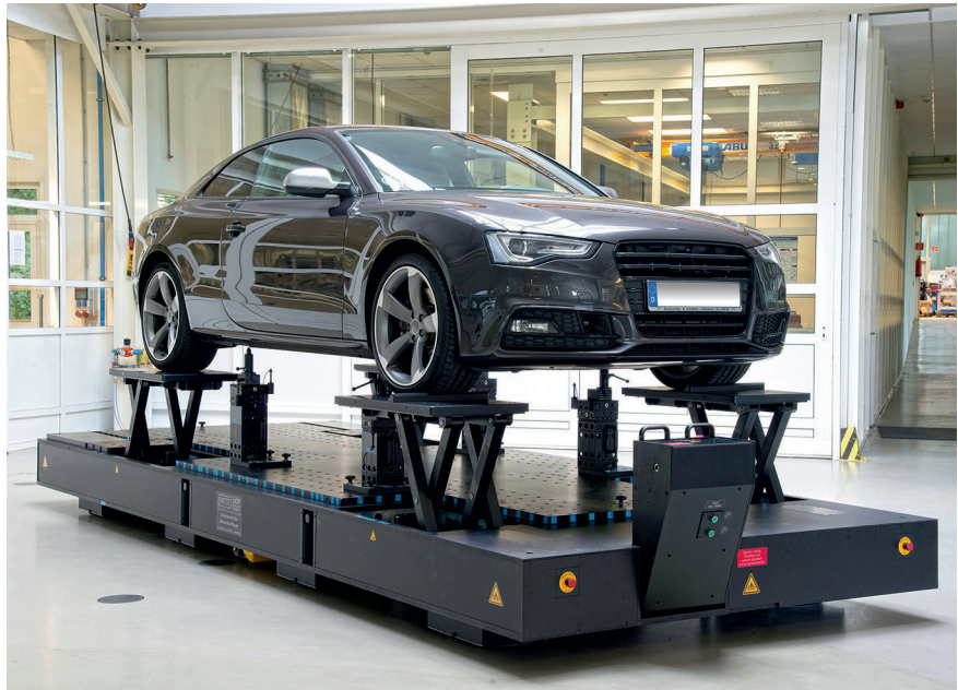
Bild 2. Strukturplatten dienen als Basis für Messaufnahmen bzw. Vorrichtungen, als Ersatz für Ausleger-KMG-Messtische sowie als Transportplatten und kubische Aufspannkörper mit fünf Nutzflächen. Hier in Kombination mit Scherenhubtischen und Z-Aufnahmen aus dem Alufix-Programm © Witte
